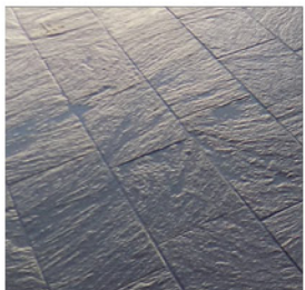
PORPHYRY PAVING Spec.: Riven Dim.: 70 x 200 x 400–600 mm Mortar: 6 mm
